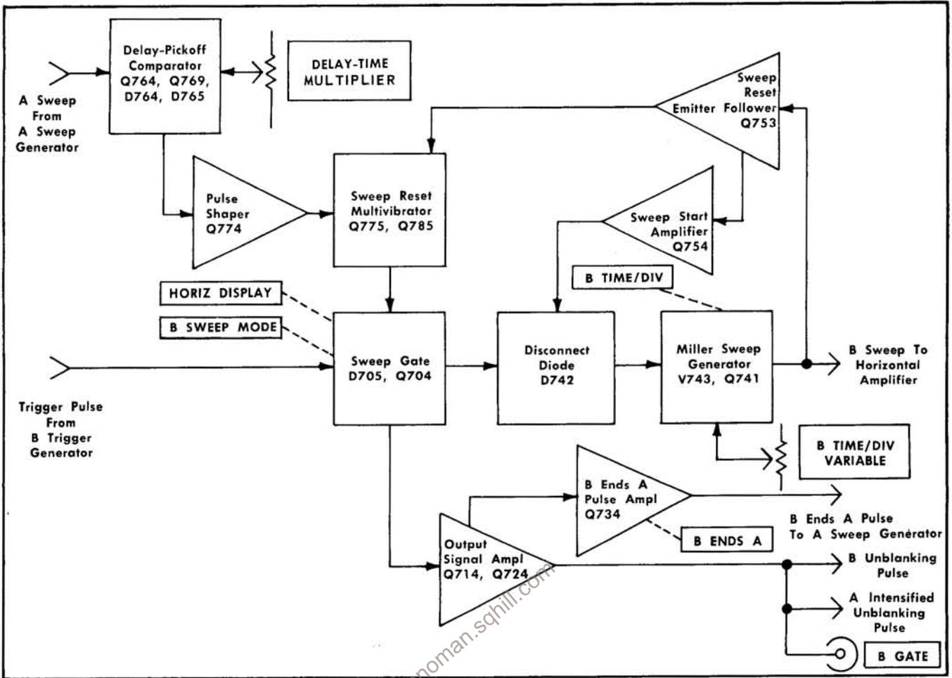
Fig. 3-9. Block diagram of B Sweep Generator circuit.
